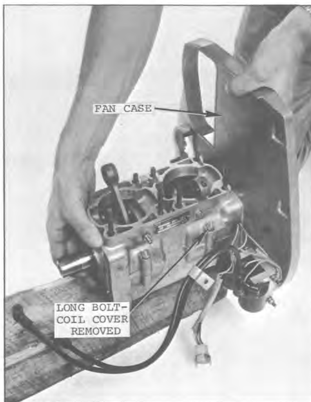
Fig. 10 — Removing/Installing Fan Case
