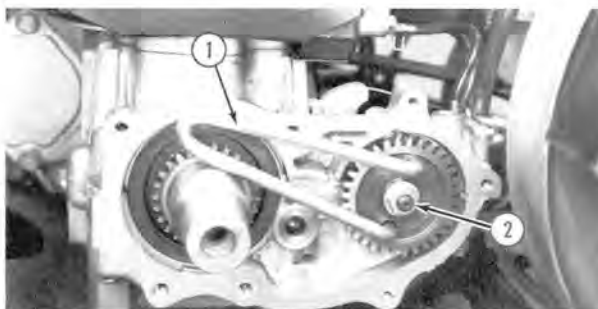
1. Fan Puller Holder 2. Nut
