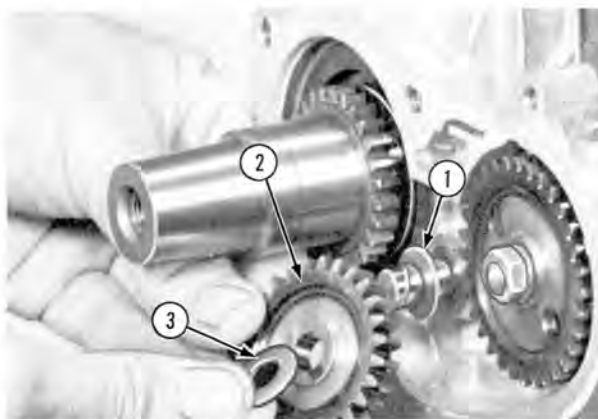
1. Spacer 2. Idler Gear 3. Spacer
